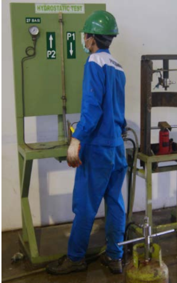
Hydrostatic Test (retest/uji ulang) pada tabung kadaluarsa/expired
